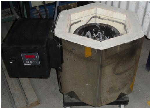
**Figura 8** Horno de crisol terminado.
