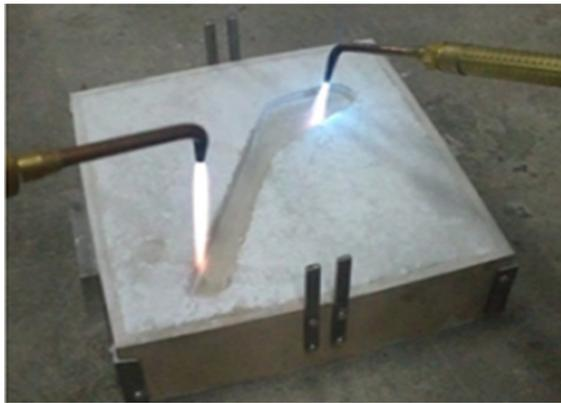
**Figura 14** Proceso de secado del molde.
