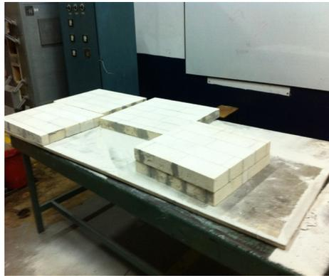
**Figura 9** Placas de ladrillo refractario
