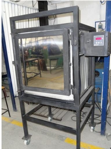
**Figura 13** Horno de tratamientos térmicos tipo Batch.
