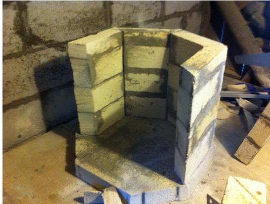
**Figura 5** Construcción del horno de crisol.
