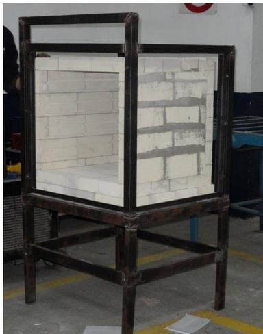
**Figura 11** Estructura metálica del horno
