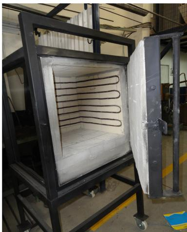
**Figura 12** Ubicación de las niquelinas en las paredes del horno para tratamientos térmicos.
