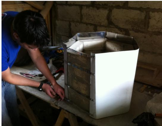
**Figura 6** Colocación de la lámina de acero inoxidable.
