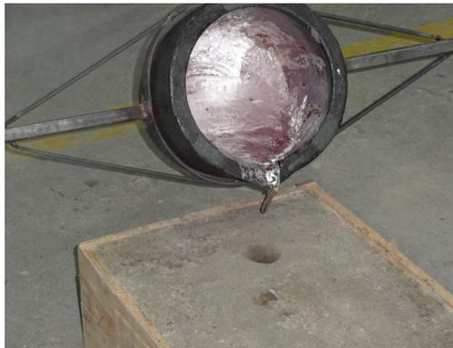
**Figura 15** Proceso de colado del metal.
